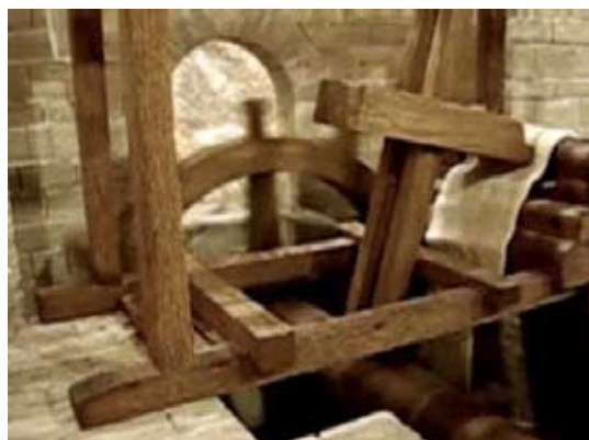
Los mazos de madera que componen una parte del mecanismo de un batán
